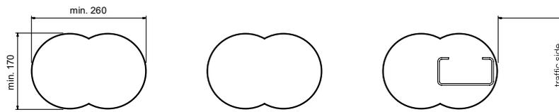
Die **Dreifachbohrung** ist durch drei überlappende Bohrungen mit einem Durchmesser von 170 mm auszuführen, so dass die Außenabmessungen der Gesamtbohrung mindestens 170 x 350 mm betragen. Nach dem Verfüllen und Verdichten der Dreifachbohrung ist der Pfosten mittig im Bohrloch zu rammen.
