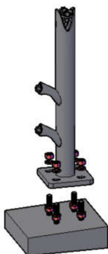
Montering av stolpe på boltegruppe.
